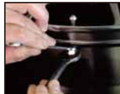
アルミアダプター 締め付けトルク T=1.5 \pm 10\% \text{N}\cdot\text{m}
